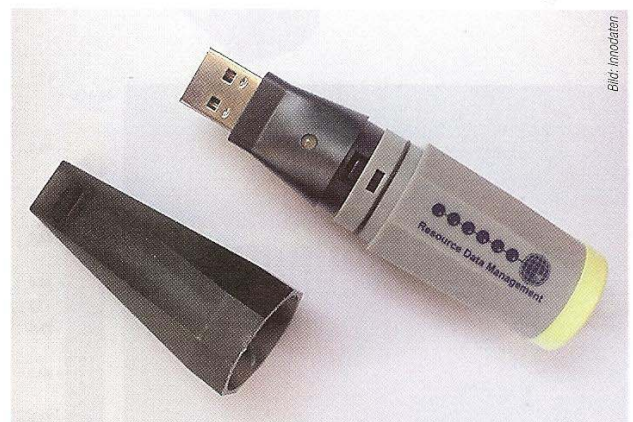
Innodaten: USB-Stick zum Aufzeichnen von Temperaturen.
