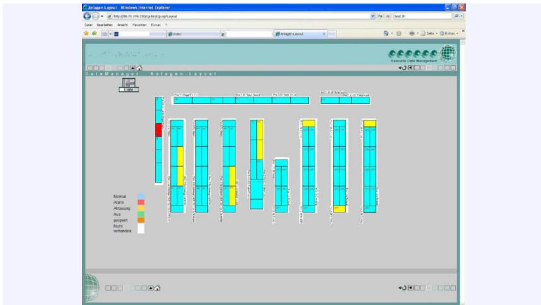
Alle unsere Produkte werden über den Internet Browser auf ihrem PC (Explorer, Firefox, Chrome, Opera,...) bedient. Durch einfaches eingeben der IP Adresse der Anlage bzw. deren Name kommt eine Verbindung über das Ethernet (LAN/WAN) zu Stande.
